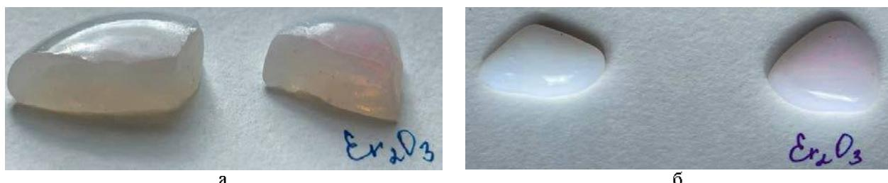
Рисунок 1. Фото образцов после доводки: а – при 750 °C, 180 мин.; б – 800 °C, 120 мин.
